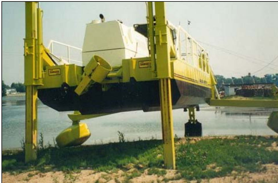
Photo 2.4 Déplacement terrestre de la drague Amphibex
